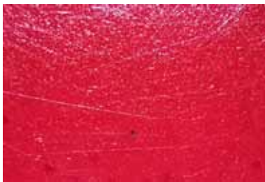
Рисунок 21. Подряпини поверхні, характерні для м'якої пластмаси
